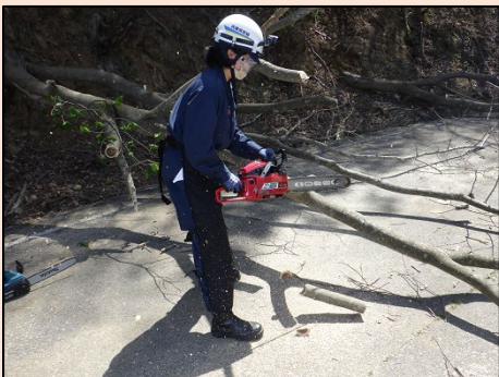
チェーンソーによる 倒木切断要領
