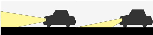
ハイビーム：照射距離 約100m ロービーム：照射距離 約40m
